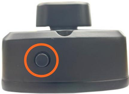
Mantenga presionado el botón de bloqueo electrónico hasta que el asistente de voz indique "Operation successful" / "Operación exitosa", indicando que el cerrojo se encuentra bloqueado. Sólo puede ser desbloqueado a través de la app del administrador o girando el volteador interior. Otros métodos de apertura no se podrán usar mientras esta función esté activa.
