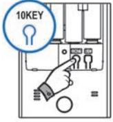
Abra la cubierta de las baterías y pulse 10KEY
